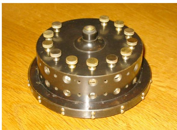
Abb. 4. Man ahnt, wie oft der Schlitten gedreht werden muss, bis ein vielstelliges Resultat abgelesen ist - dies trifft in geringerem Maße auch auf die Umdrehungsstellen zu. Die Schrauben auf dem Wulst fixieren die Federn, die in Schächten gelagert, die Zahnradstellungen sichern (rechts, aus Hamanns Patent (D)).
