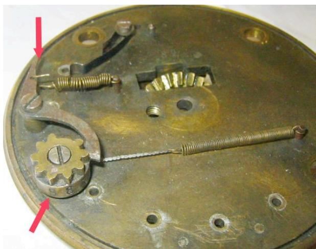
Abb. 14. Die Unterseite des Deckels aus Abb. 12., also die untere Abdeckung des Rechenwerks. Man erkennt den Durchbruch für das Antriebskegelrad.
