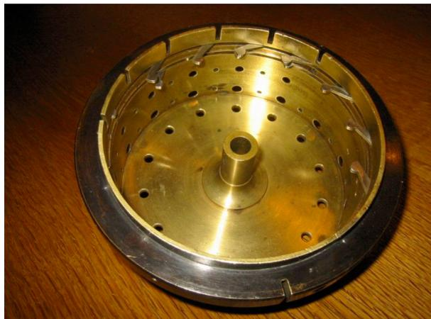
Abb. 5, der Rundschlitten ohne Zählwerke. Man erkennt die im Wulst gelagerten Schleppsicherungen der Zählwerke.
