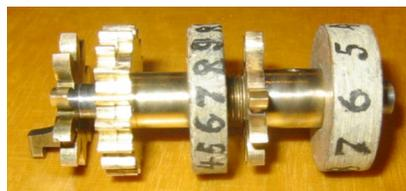
Abb. 7 (oben). Eine der zweiteiligen Zählwerkwellen, v.l.n.r.: Kupplung zum Rechenwerk, Zählzahnrاد des UZW plus Löschrاد (mit Zahn-lücke) des UZW, Distanzhülse, Ziffernrاد des UZW, Löschrاد (mit Zahn-lücke) des RZW, Distanzhülse, Ziffernrاد des RZW.
